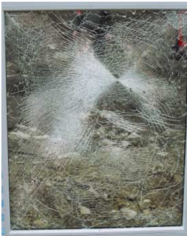
Das Glas der ersten - nicht gehärteten Scheibe bricht in Splitterform weg.
