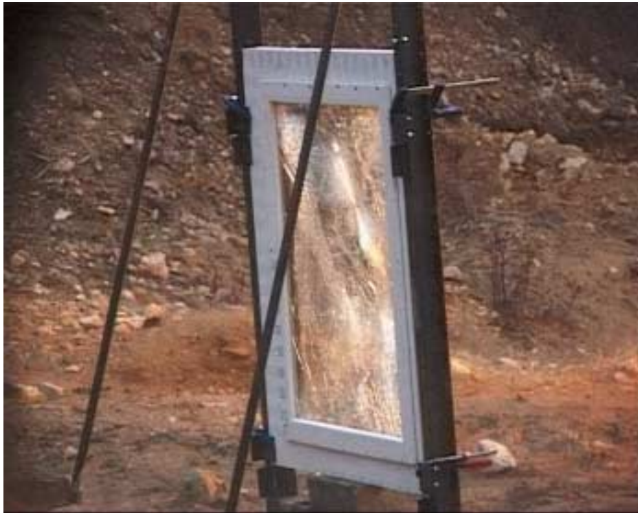
Abb. zeigt Ergebnisse bei Versuch 3. Das Fenster als solches hält der Belastung stand . Dabei berstet die nicht verstärkte Glasfront durch den Druck und wird in der Phase des Unterdruckes (siehe Bild Richtung Explosionsstelle gesogen). Die Helligkeit im Bild ist durch den Detonationsblitz hervorgerufen.
